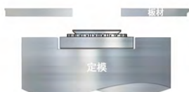
对正安装板材
